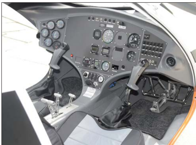
■ Dva pohledy do kabiny Cavalonu. Řídící páky jsou před oběma piloty, ovládní motoru pouze na středovém panelu
