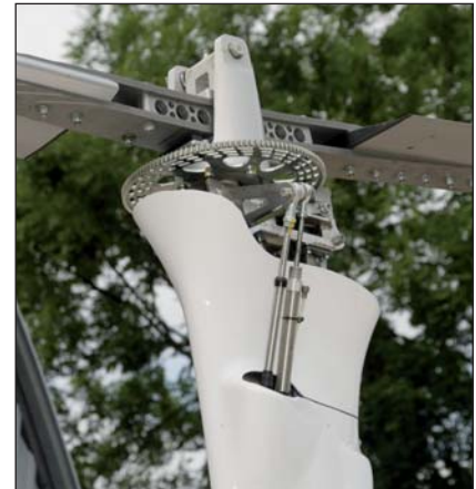
■ Hlava nosného rotoru Cavalonu s pevně uchycenými listy a prvky ovládání
