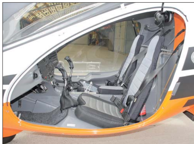
■ Dva pohledy do kabiny Cavalonu. Řídící páky jsou před oběma piloty, ovládní motoru pouze na středovém panelu
